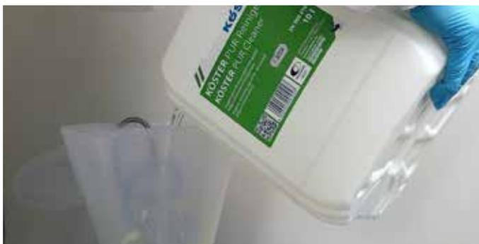
**5** Kada završite, očistite pumpu sa KÖSTER PUR Čistačem
